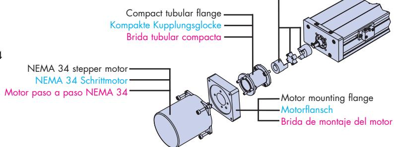
Werkseitig angebrachte Motoren bieten eine kostengünstige Lösung. Sie können auch bei hohen Geschwindigkeiten und Stoßbelastungen eingesetzt werden. Viele Motoren können optional auch mit Haltebremse, Encoder zur Positionierung und Umrichter zur Spannungsversorgung und Steuerung geliefert werden.
